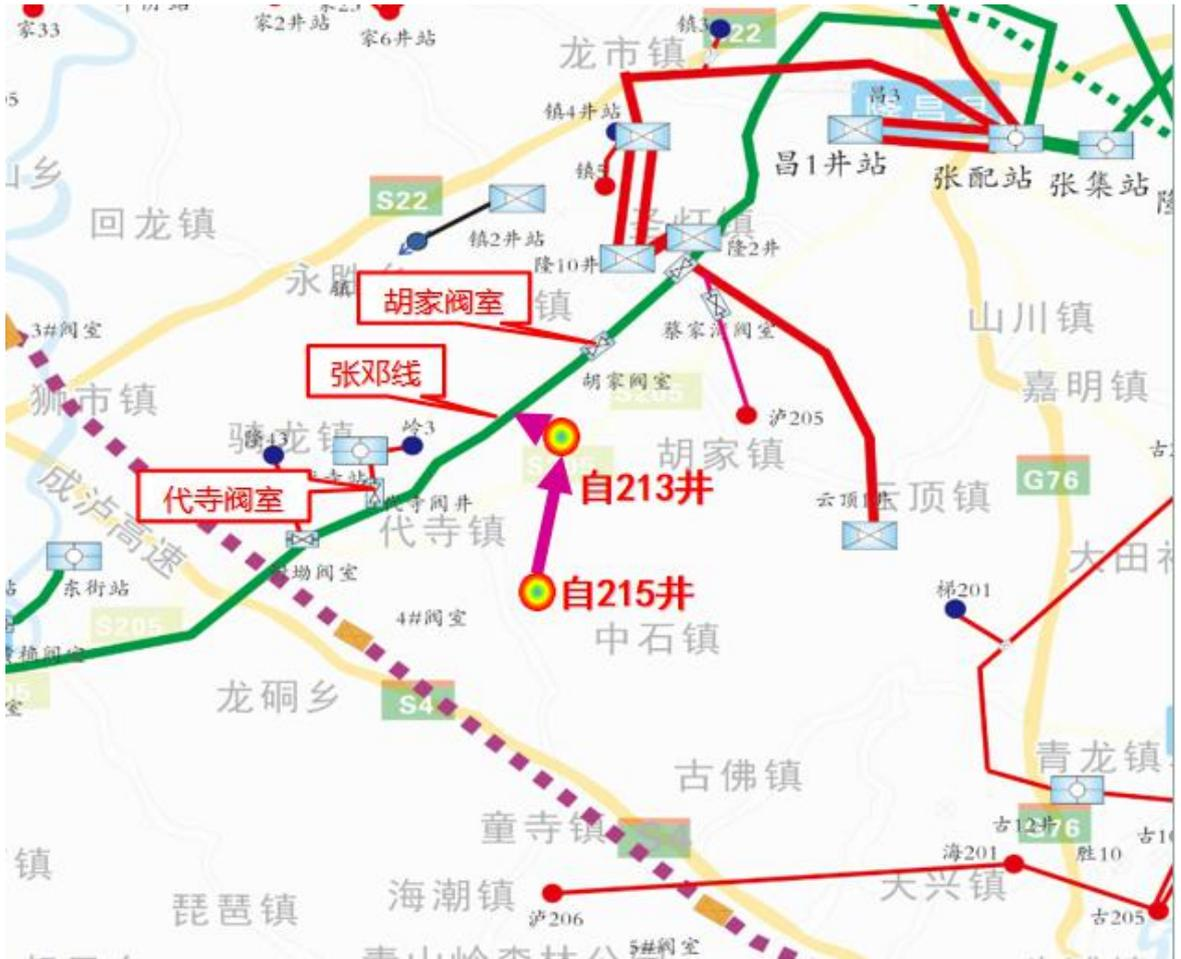
图 3.2-1 自 213、215 井站外输方案示意图
